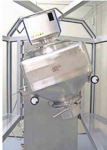
In modernen Fischzuchtanlagen (l.) überwachen Sensoren von Sentronic die Sauerstoffkonzentration. Rechts ist ein Pharmamischer mit NIR-Prozessspektrometer zu sehen.
